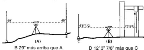
Arriba se muestra una línea de visión de 69 pulgadas por encima de A y 40 pulgadas por encima de B. Por lo tanto, B se encuentra 29 pulgadas por encima de A.
