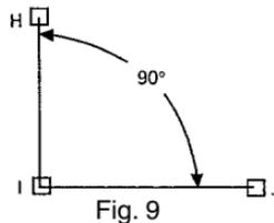
En los trabajos de planificación, frecuentemente es necesario fijar un ángulo, generalmente de  $90^\circ$ . Supongamos que se debe determinar el ángulo HIJ de  $90^\circ$  y los puntos H e I se muestran (Fig. 9). Por lo tanto, J es el punto que se debe fijar.
