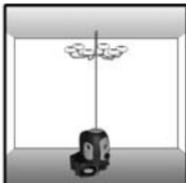
Referencia a plomo para instalación de lámparas
